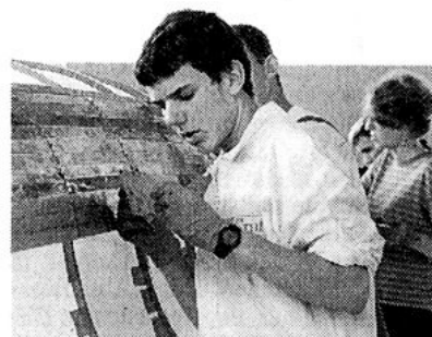
Die Holzleisten werden mit Epoxidharz verleimt. Fotos: zVg
